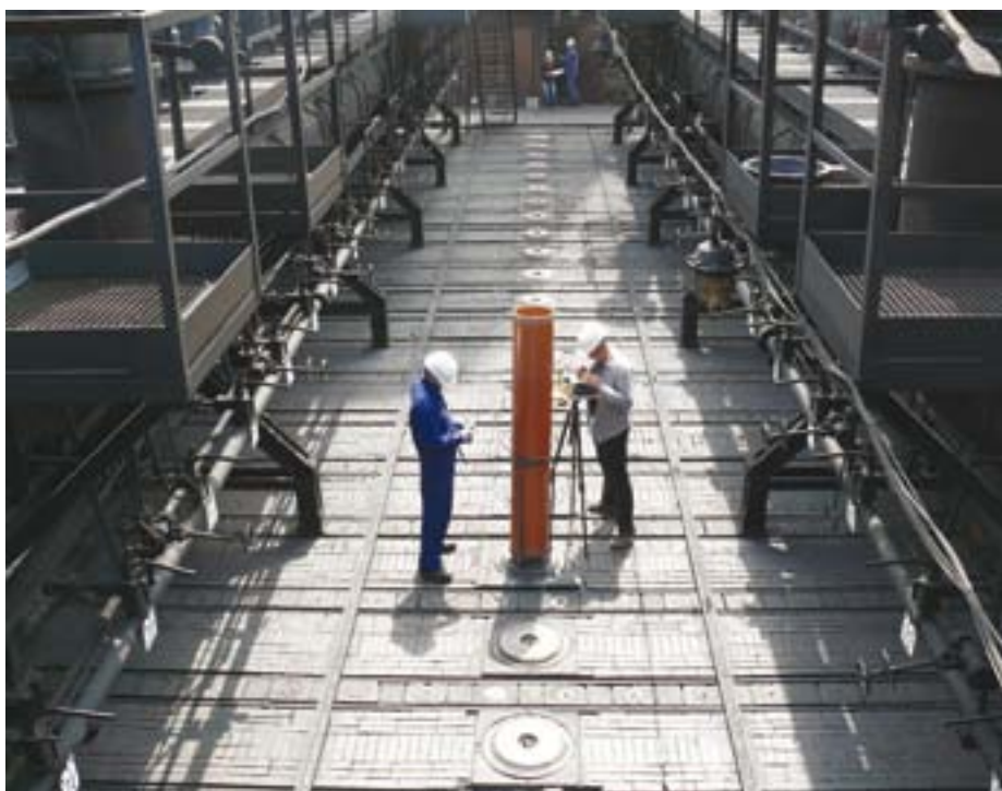
Fot. 3. Pracownicy IChPW podczas badań na stropie baterii koksowniczej
